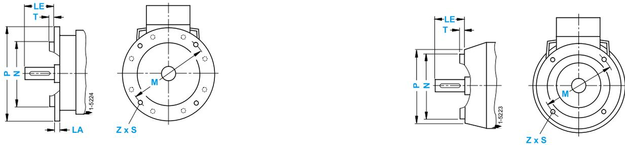
В DIN EN 50 347 для каждого типоразмера предписываются соответствующие размеры фланцев типа FF с гарантированным зазором и фланцев типа FT с резьбовым отверстием. Стандарт DIN 42948 для фланцев типа А и С остается действующим. См. таблицу соответствия ниже. (Z – число отверстий для крепления)
