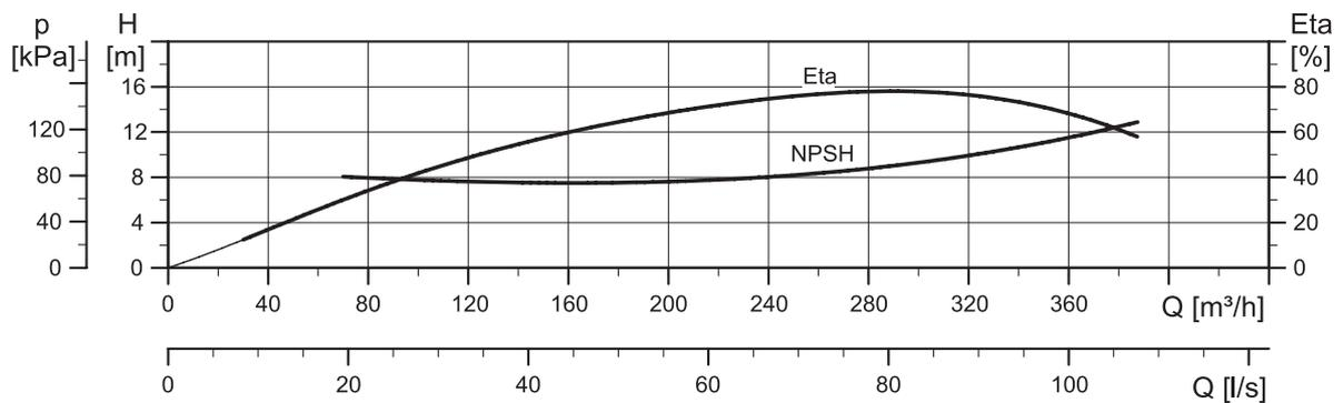
**Примечание:** Кривая NPSH одинаковая для всех типов рабочего колеса. Кривая КПД представлена для рабочего колеса типа F. Для всех остальных типов рабочего колеса необходимо вычислять величину КПД. Смотрите «Вычисление КПД» на стр. 11.
